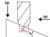
Diametro effettivo per frese semisferiche con angolo di penetrazione  $\beta=0^\circ$  / Effective diameter for ball nose end mills at a set angle  $\beta=0^\circ$  / Effektiver Durchmesser für Nutenfräser mit Eintauchwinkel  $\beta=0^\circ$  / Diamètre effectif pour fraises à bout hémisphérique pour un angle du taillant de  $\beta=0^\circ$
