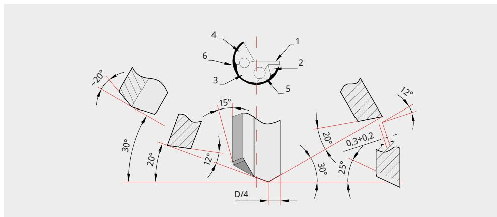
Die Silmax-Standardgeometrie wurde speziell entwickelt, um Bohrungen bei einem breiten Spektrum an Materialien mit optimalen Ergebnissen vorzunehmen zu können. In besonderen Situationen, wie zum Beispiel bei langen Spänen oder schwer zerspanbaren Werkstoffen, sind wir jedoch in der Lage geometrische Sonderlösungen zu realisieren,
