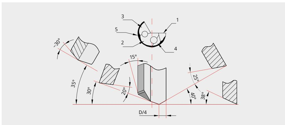
La geometria standard Silmax è stata appositamente studiata per permettere di forare un ampio spettro di materiali con risultati ottimali. Tuttavia nelle situazioni particolari come per esempio materiali a truciolo lungo o difficilmente truciolabili, siamo in grado di realizzare soluzioni specifiche di geometria intervenendo su
