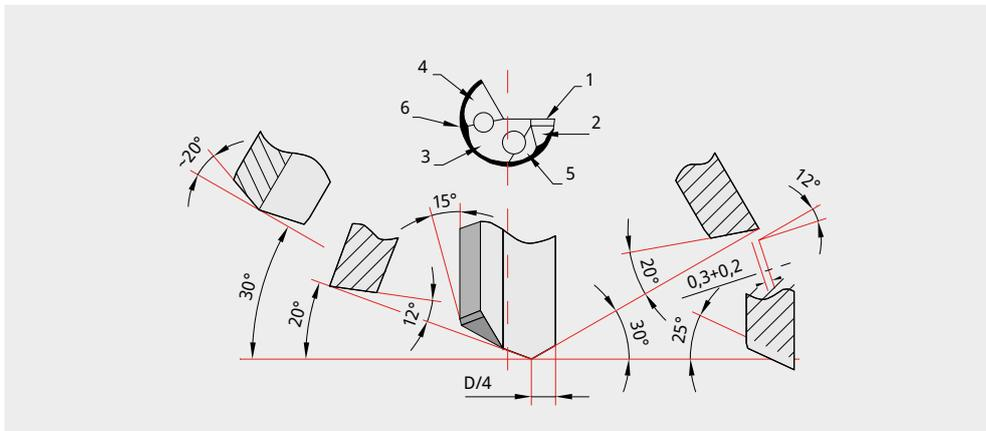
Affilatura standard per punte a cannone monotaglienti con diametro da 5 a 30 mm
