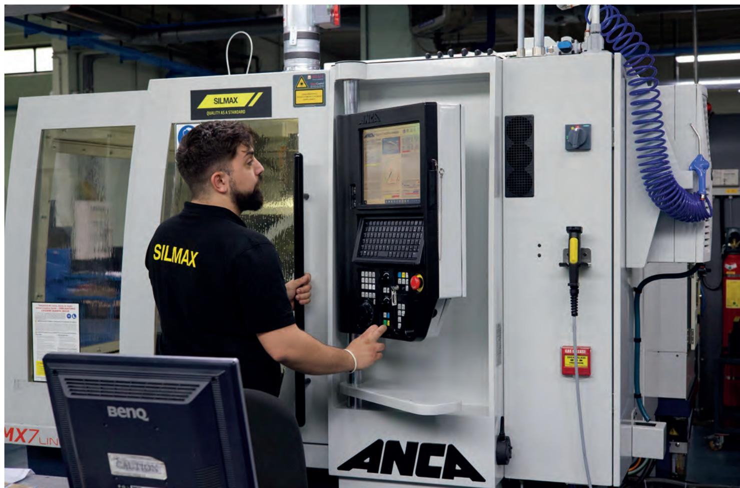
Silmax utilizza moderne affilatrici dotate di strumenti di misura al laser che permettono di monitorare il processo produttivo in tempo reale di ogni singolo utensile.
