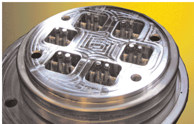
Esempio di matrice lavorata con le nuove frese Silmax HM90
