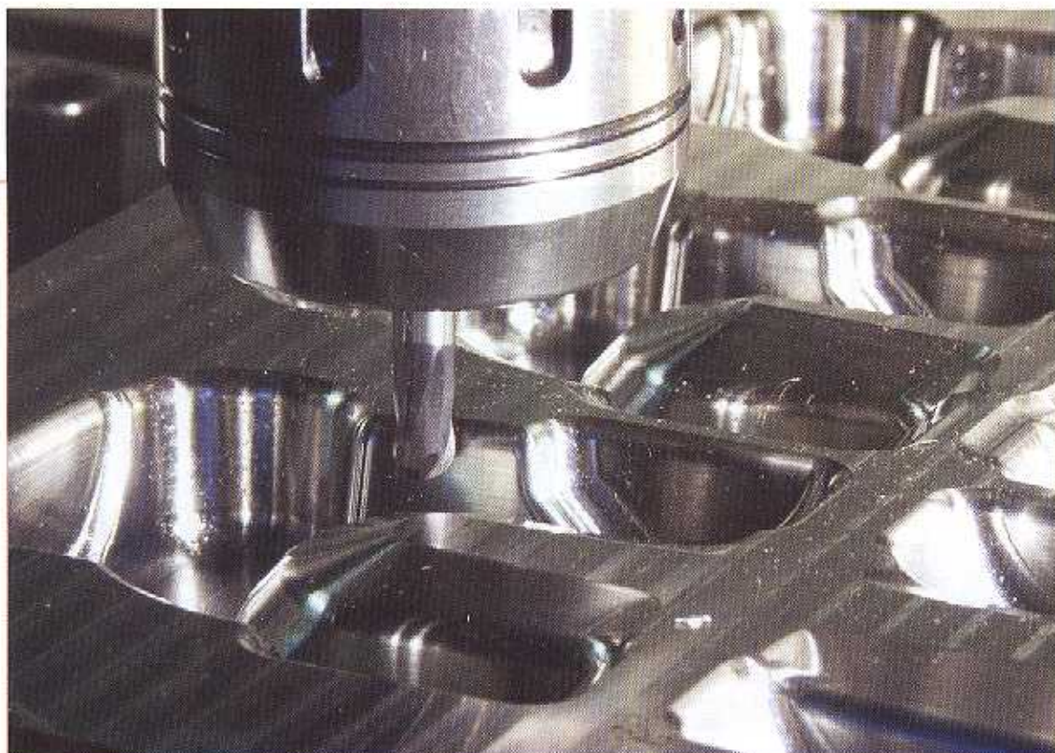
Lavorazione di uno stampo con utensile Silmax.
